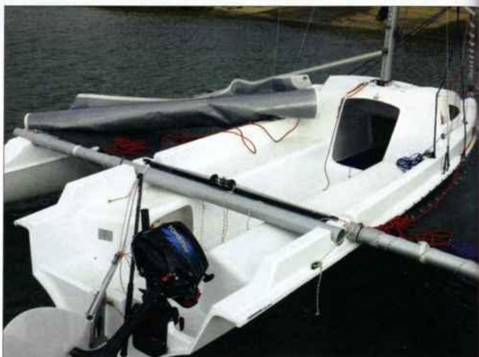
▲ Les poutres arrière servent de support à la barre d'écoute. Le reste du cockpit est parfaitement dégagé, y compris l'accès à la descente.
