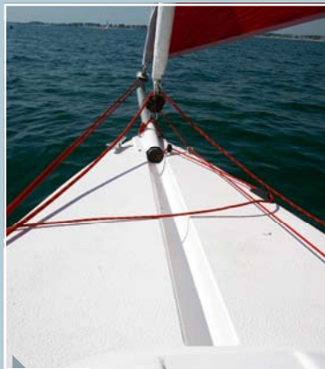
La plage avant avec sa gouttière. Moyen pour les manœuvres de mouillage.
