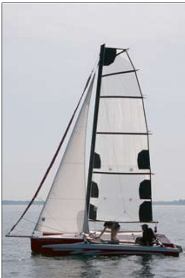
▲ Le gréement Sport présente une belle grand-voile en film (Mylar/Glitter).
