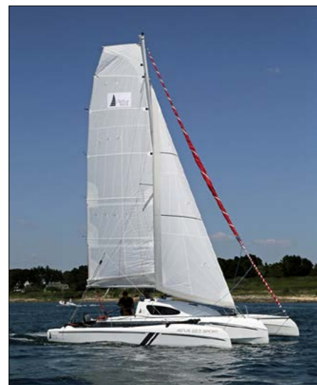
▲ La GV à corne apporte un surplus de puissance contrebalancé par un foc de taille raisonnable.
